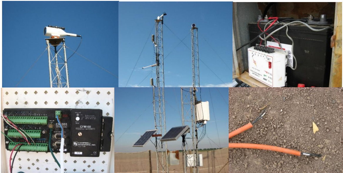
Figura 5. Instrumentación instalada en el cultivo de chile.
